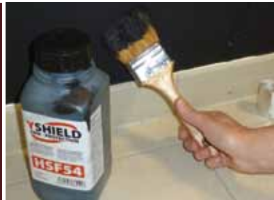
Peinture écran, au graphite. À droite sur le mur : fil (noir) de mise à la terre, avec une cosse à œil. Au sol : rouleau de feuille alu autocollant, pour la mise à la terre (une frange est visible, en haut de la plinthe).
