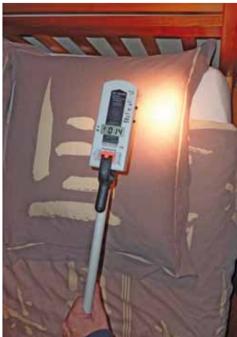
Mesure de champ électrique à la tête du lit. La perchette en plastique permet une mesure en champ non perturbé.
