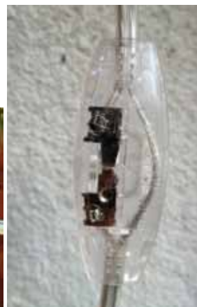
Interrupteur unipolaire. Utilisable à condition qu'il coupe le fil de phase.
