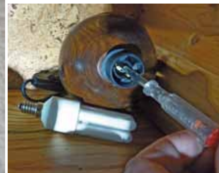
Vérification de la coupe de la phase par l'interrupteur, avec un tournevis testeur. Ici, ce n'est pas le cas : la lampe néon s'allume.
